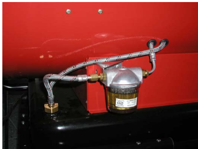
ILL. 2: particolare gruppo filtro gasolio
